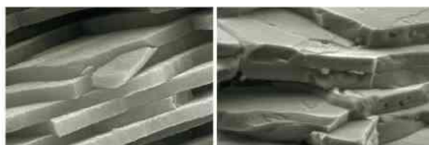
À l'échelle du nanomètre, les deux matériaux (nacre et céramique) présentent la même structure en « briques et mortier ».
